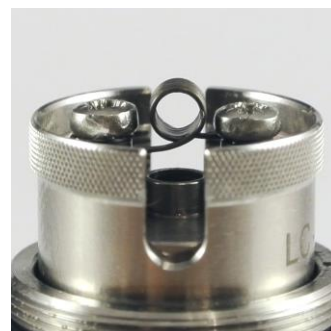
Bild 8: Die Wicklung sollte sich nun genau mittig befinden und ca. 1-1,5mm über dem Luftloch schweben.
