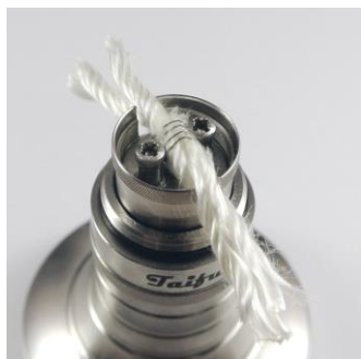
Bild 29: Die Drahtenden werden möglichst bündig abgeschnitten.
