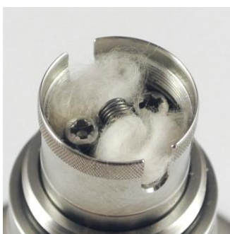
Bild 11: Die Watte innerhalb der Verdampferkammer verteilen.
