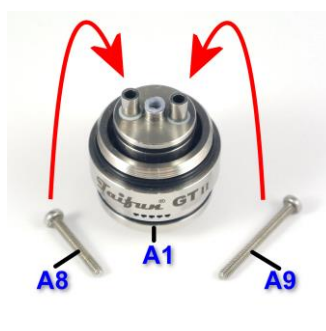
Bild 7: Die beiden Schrauben für den Minuspol (A8) und den Pluspol (A9) werden in die dafür vorgesehenen Röhren in der Base (A1) gesteckt.
