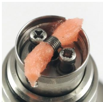
Bild 18: Die Watte wird mit Liquid befeuchtet, und seitlich eingekürzt, so dass noch ca. 0,5-1mm übersteht.
