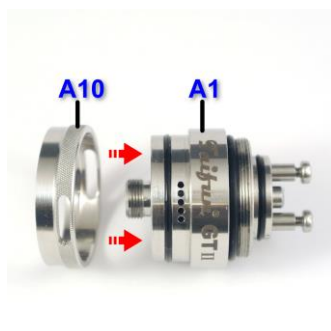
Bild 9: Der AFC Ring (A10) wird nun von unten auf die Base (A1) festgehalten und dort von dem O-Ring (A16) festgehalten.
