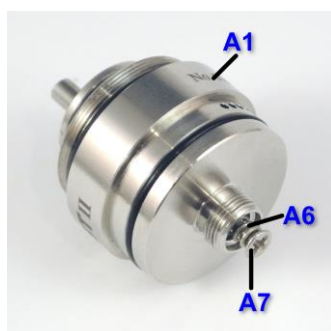
Bild 5: Die Senkkopfschraube (A7) wird festgezogen und bildet somit den Pluspol.
