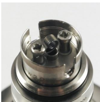
Bild 7: Dabei ist darauf zu achten, dass die Enden der Drähte nicht die Kammerhülse berühren.
