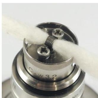
Bild 10: Eventuell noch etwas Watte wegnehmen, so dass sie zwar stramm sitzt, sich aber immer noch in der Wicklung bewegen lässt.
