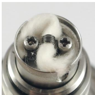
Bild 21: Die Watte wird S-förmig in der Verdampferkammer verlegt
