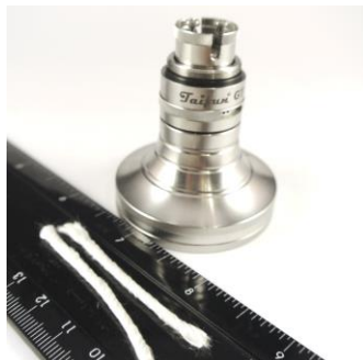
Bild 25: Auch eine Wicklung mit Silikatfaser (z.B. 3mm) ist möglich.
