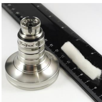
Bild 9: Man benötigt nun einen ca. 2-4 mm breiten Wattestreifen, der durch die Wicklung geführt wird.
