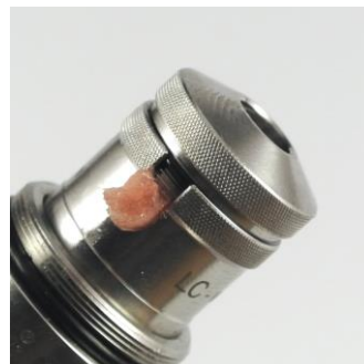
Bild 20: Der Kammerdeckel wird aufgeschraubt. Dabei muss man darauf achten die Watte nicht abzuschneiden.
