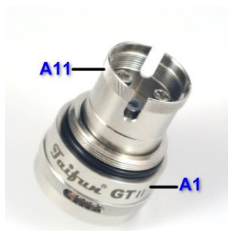
Bild 11: Nun wird die Kammerhülse (A11) von oben auf die Base (A1) gesteckt. Sie rastet an der dafür vorgesehenen Stelle spürbar ein.
