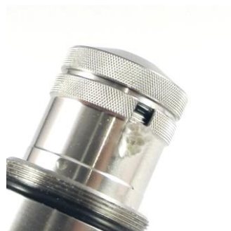
Bild 32: Die Fasern sollten noch ca. 0,5-1mm aus der Hülse heraus schauen.
