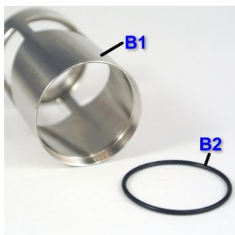
Bild 17: Der O-Ring (B2) wird in die Tankhülse (B1) gesteckt und sorgt hier später für einen guten Sitz des Tanks.
