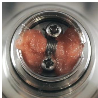
Bild 14: Die Watte füllt nun die Verdampferkammer gut und gleichmäßig aus.
