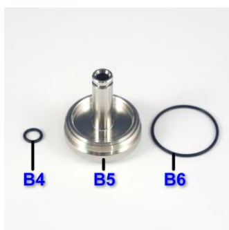
Bild 21: Auf der Topcap (B5) werden die O-Ringe (B4, B6) angebracht.
