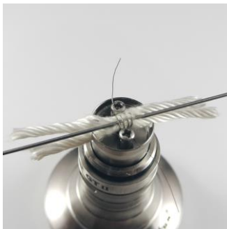
Bild 27: Mithilfe einer Wickelhilfe (z.B. Büroklammer) wird die Wicklung ausgerichtet.
