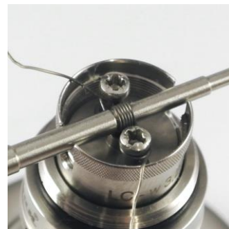
Bild 4: Der Draht wird unter die Schrauben gelegt. Diese werden anschließend vorsichtig festgezogen.
