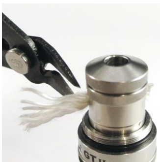
Bild 31: Überstehende Fasern werden beidseitig abgeschnitten.
