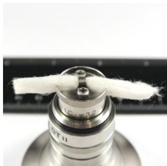
Bild 17: Der Wattestrand wird durch die Öffnungen der Verdampferkammer nach außen geführt.
