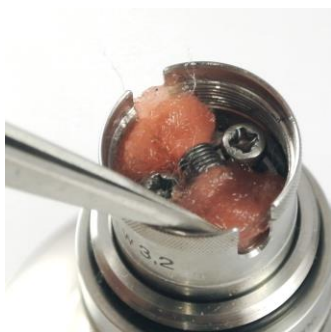
Bild 13: Nun kann man die Watte ggf. noch etwas ausrichten, so dass Liquid gut aufgenommen werden kann.
