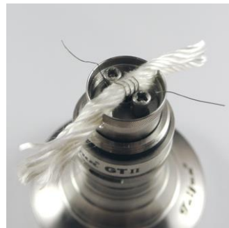
Bild 28: Nach dem Festschrauben der Drähte kann die Wickelhilfe entfernt werden, und die Wicklung ggf. nochmals korrigiert werden.
