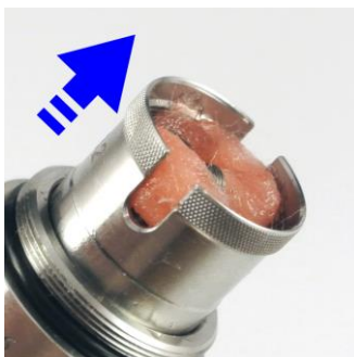
Bild 23: Beim Hochziehen der Kammerhülse darauf achten, dass die Watte an ihrer Position bleibt.
