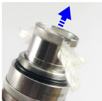
Bild 30: Nun sollte die Kammerhülse wieder nach oben geschoben werden.
