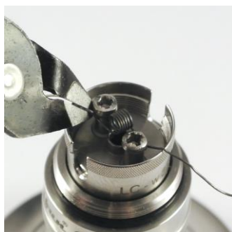
Bild 6: Mithilfe einer Zange oder einem anderen geeigneten Werkzeug werden die Drähte nun beidseitig eingekürzt.
