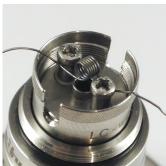
Bild 5: Die Wicklung mit der Wickelhilfe noch etwas ausrichten, und danach die Wickelhilfe entfernen.
